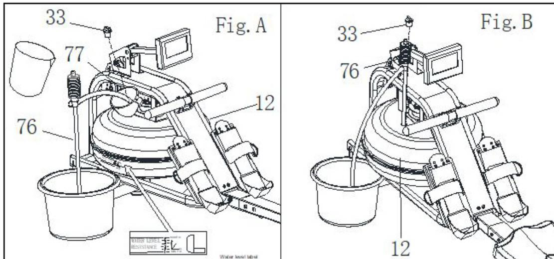
1. Entfernen Sie den Stopfen vom Tank und stellen Sie ein Gefäß mit Wasser daneben. Führen Sie den Auslauf des Tanks ein und stellen das Ansaugrohr in das Wasser.
