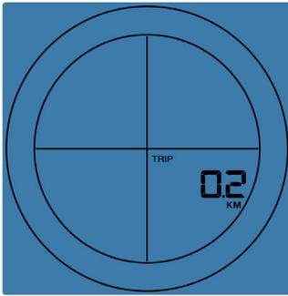
Registriert die Entfernung in 0,1 km Schritten (0 – 999.0Km). Die Entfernung ist ein theoretischer Wert, und kann nicht mit der realen Geschwindigkeit beim Radfahren verglichen werden.
