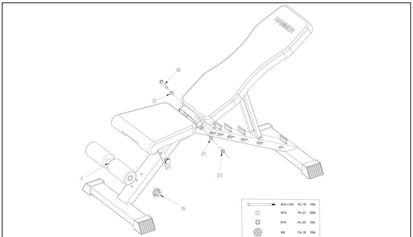
Für die Montage der Rollen nutzen Sie bitte die Schrauben (25) und Unterlegscheiben (22).
